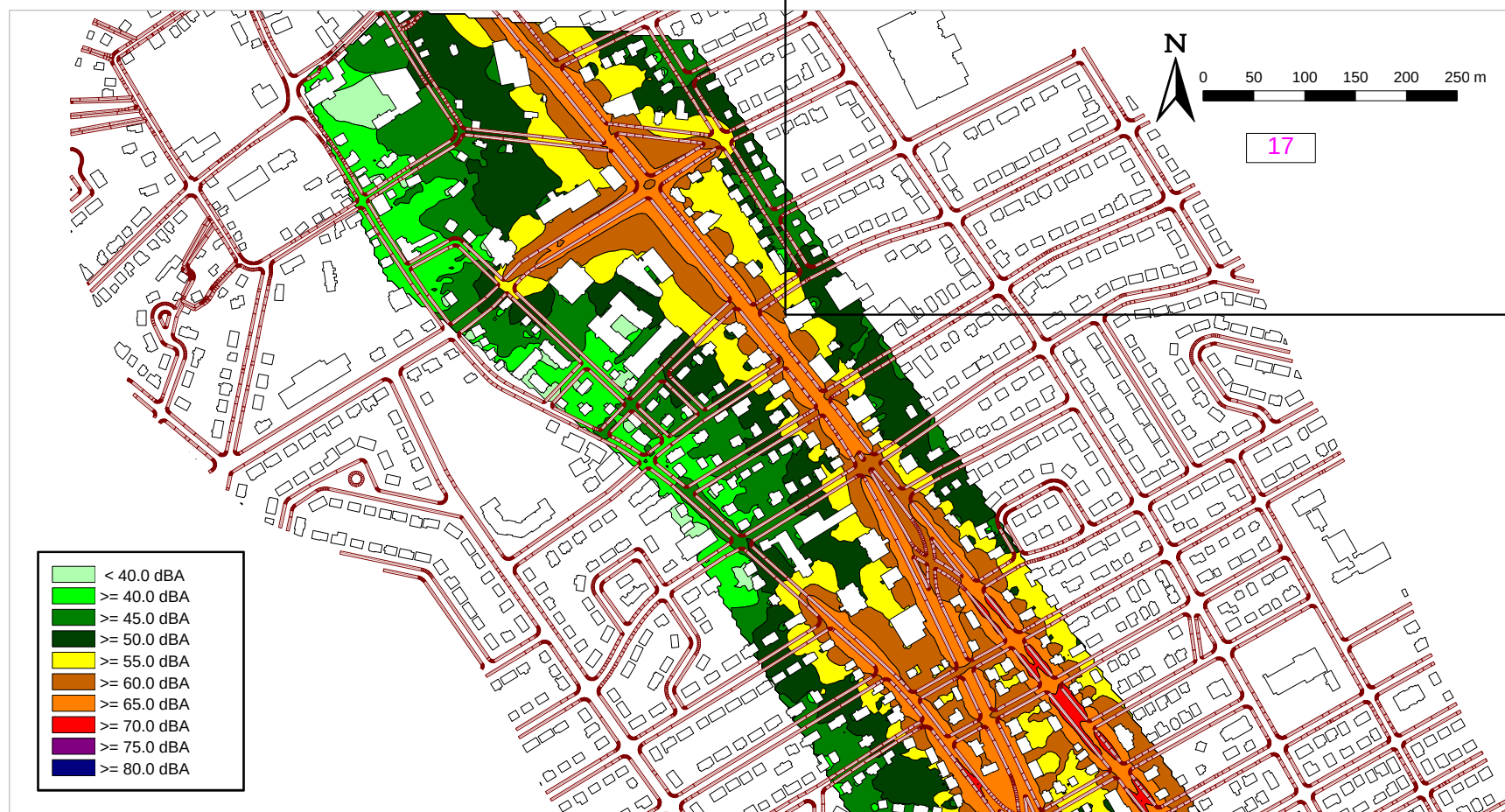
Figure 50 : Cartographie de bruit – Secteur 76 e Rue – Niveau de bruit L_p – Hauteur 4 m – Échelle 1/4000 e
