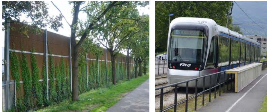
Figure 123 : Exemples d'écrans antibruit
