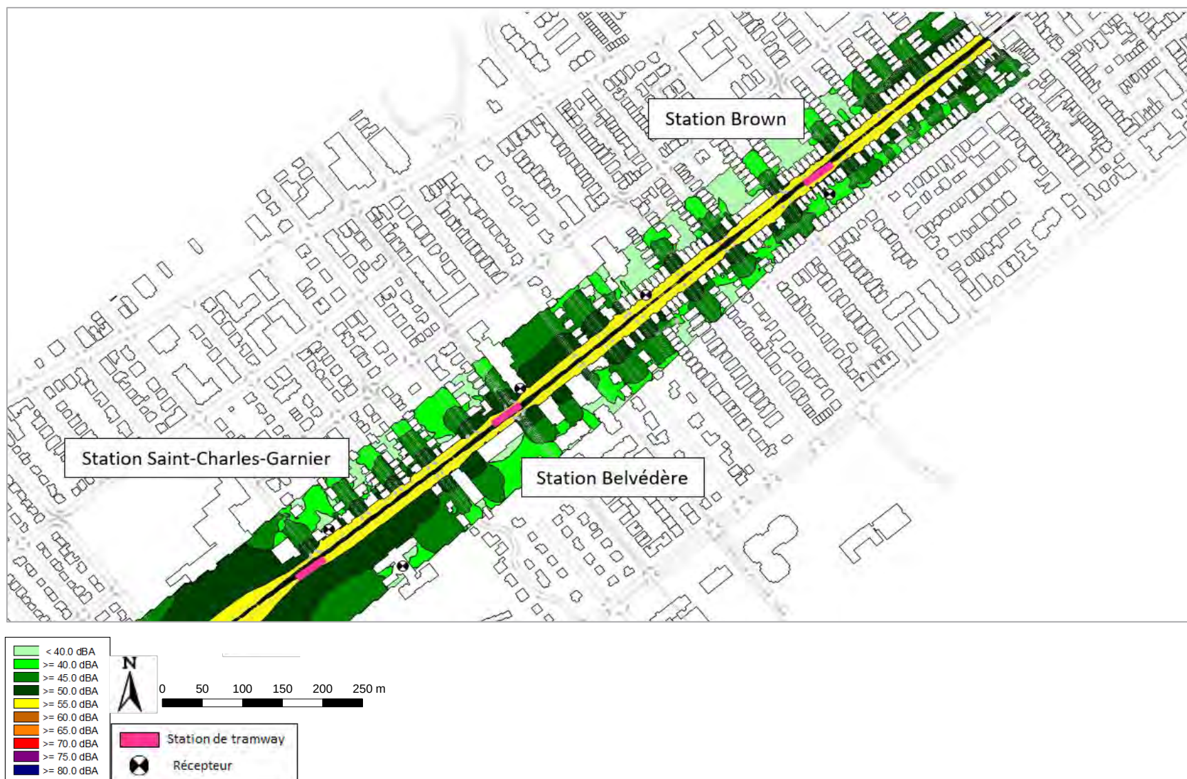
Figure 155 : Cartographie de bruit pour le tramway seul avec mesures de réduction – Secteur Belvédère – Niveau de bruit LN – Hauteur 4 m – Échelle 1/4000 e
