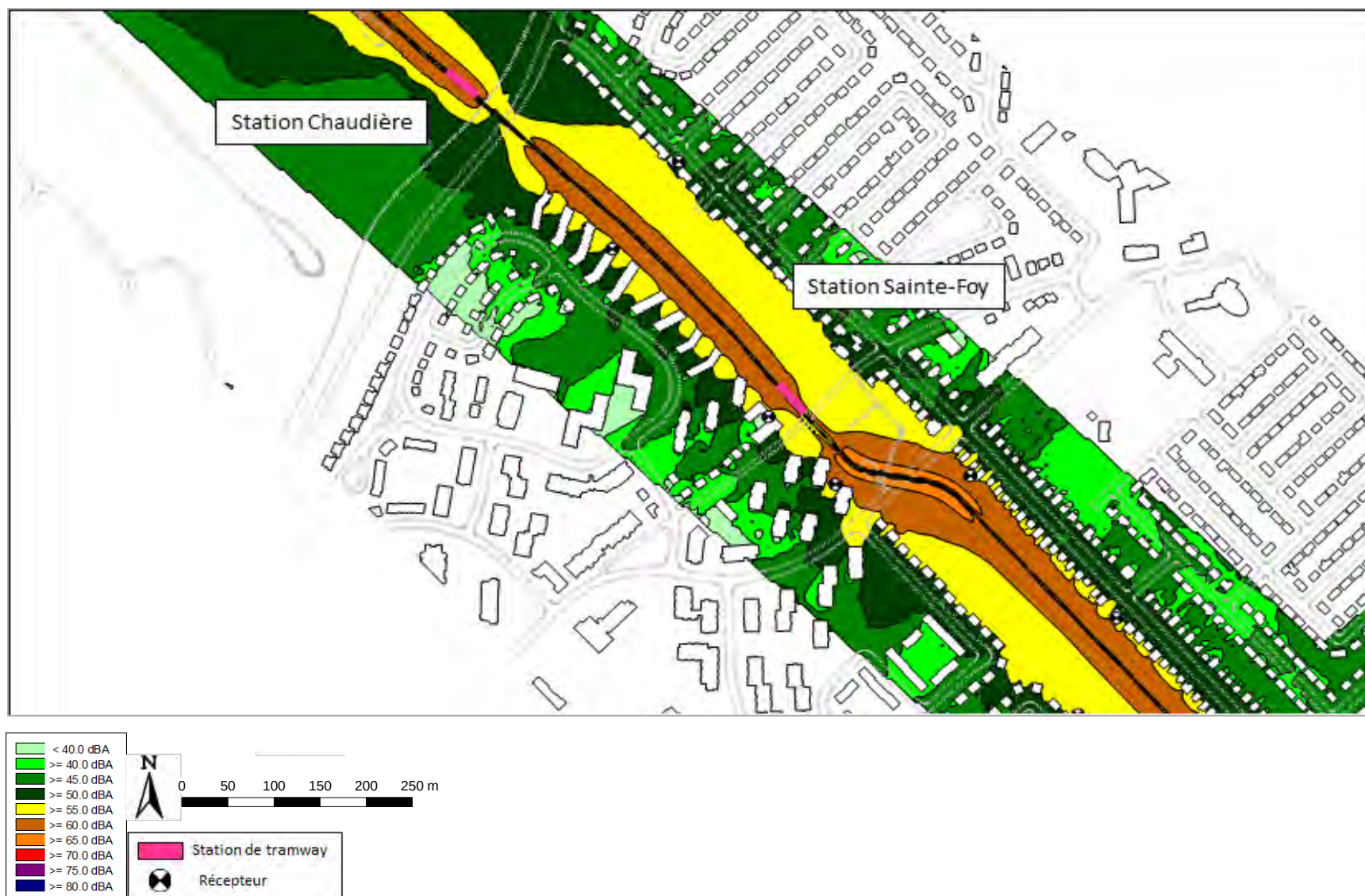
Figure 61 : Cartographie de bruit pour le tramway seul – Secteur Saint-Foy – Niveau de bruit LN – Hauteur 4 m – Échelle 1/4000°
