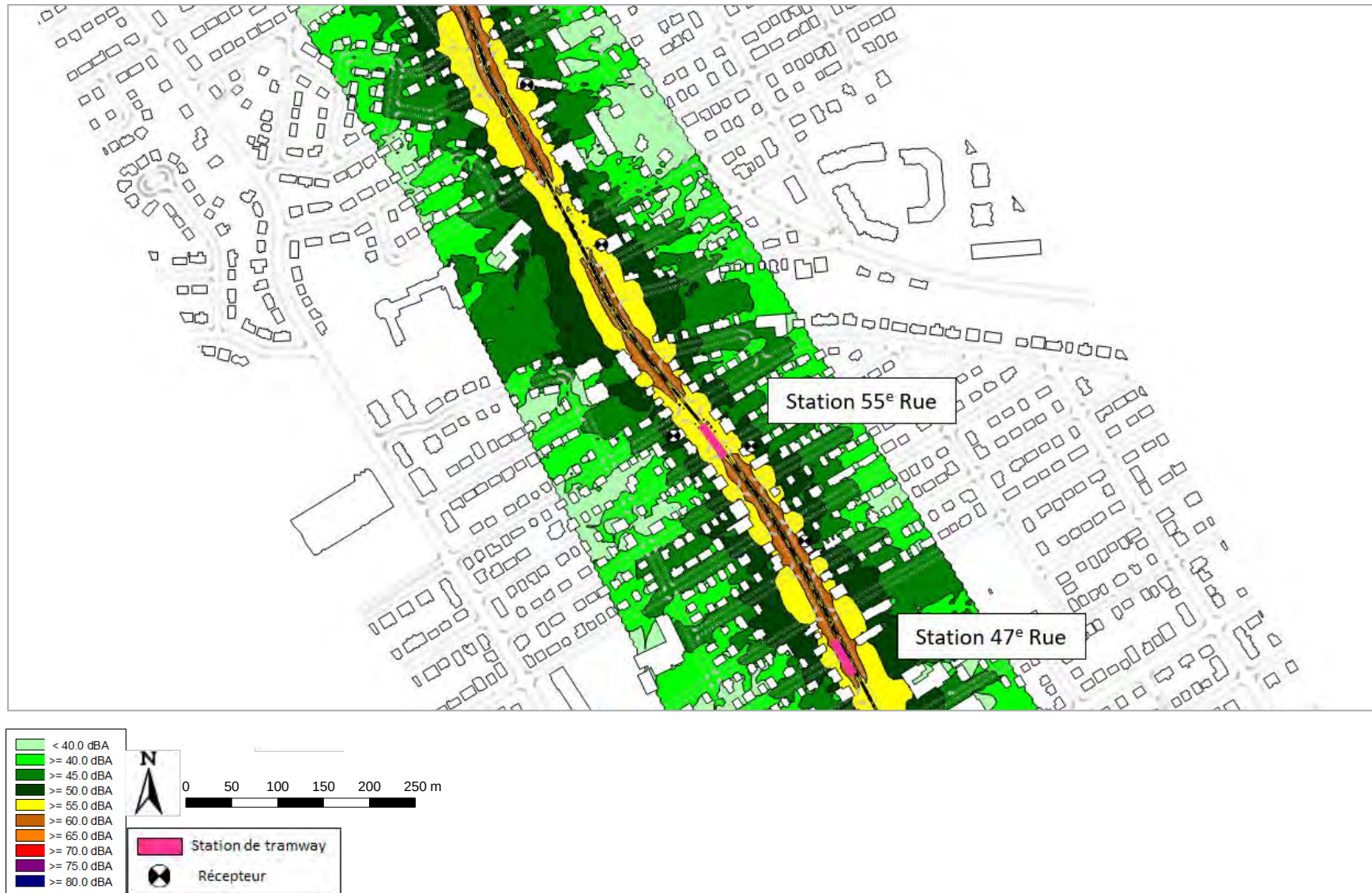
Figure 103 : Cartographie de bruit pour le tramway seul – Secteur 55 e Rue – Niveau de bruit LN – Hauteur 4 m – Échelle 1/4000 e
