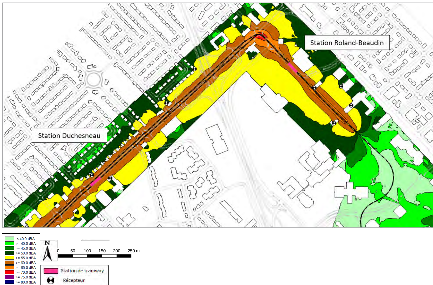
Figure 66 : Cartographie de bruit pour le tramway seul – Secteur Roland-Beaudin – Niveau de bruit LD – Hauteur 4 m – Échelle 1/4000 e
