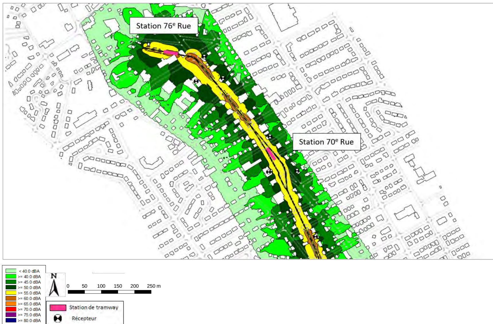
Figure 178 : Cartographie de bruit pour le tramway seul avec mesures de réduction – Secteur 76 e Rue – Niveau de bruit L_D – Hauteur 4 m – Échelle 1/4000 e
