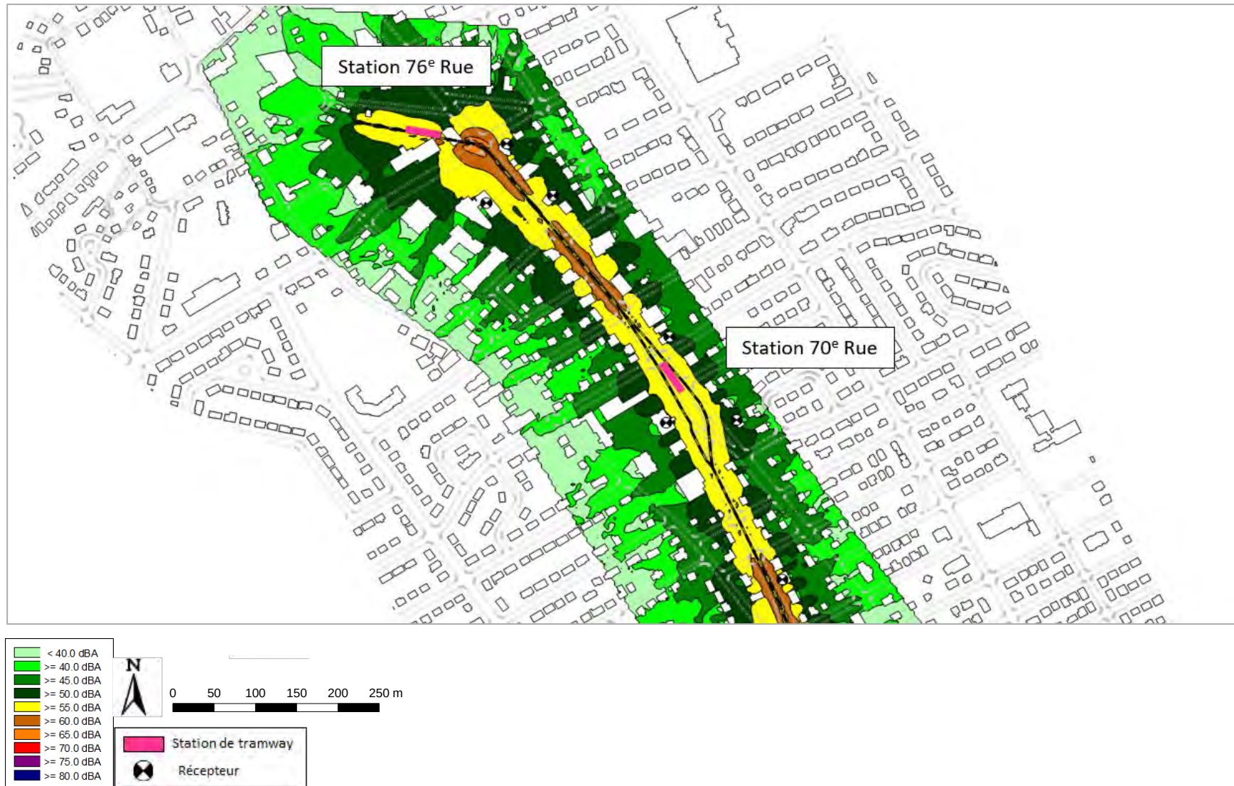
Figure 106 : Cartographie de bruit pour le tramway seul – Secteur 76 e Rue – Niveau de bruit LN – Hauteur 4 m – Échelle 1/4000 e
