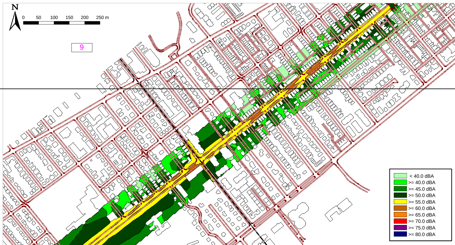
Figure 35 : Cartographie de bruit – Secteur Belvédère – Niveau de bruit L_N – Hauteur 4 m – Échelle 1/4000°
