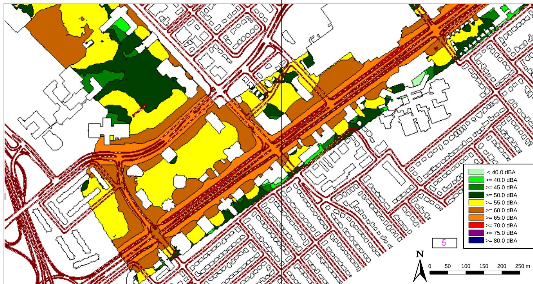
Figure 26 : Cartographie de bruit – Secteur Sainte-Foy– Niveau de bruit L_D – Hauteur 4 m – Échelle 1/4000 e
