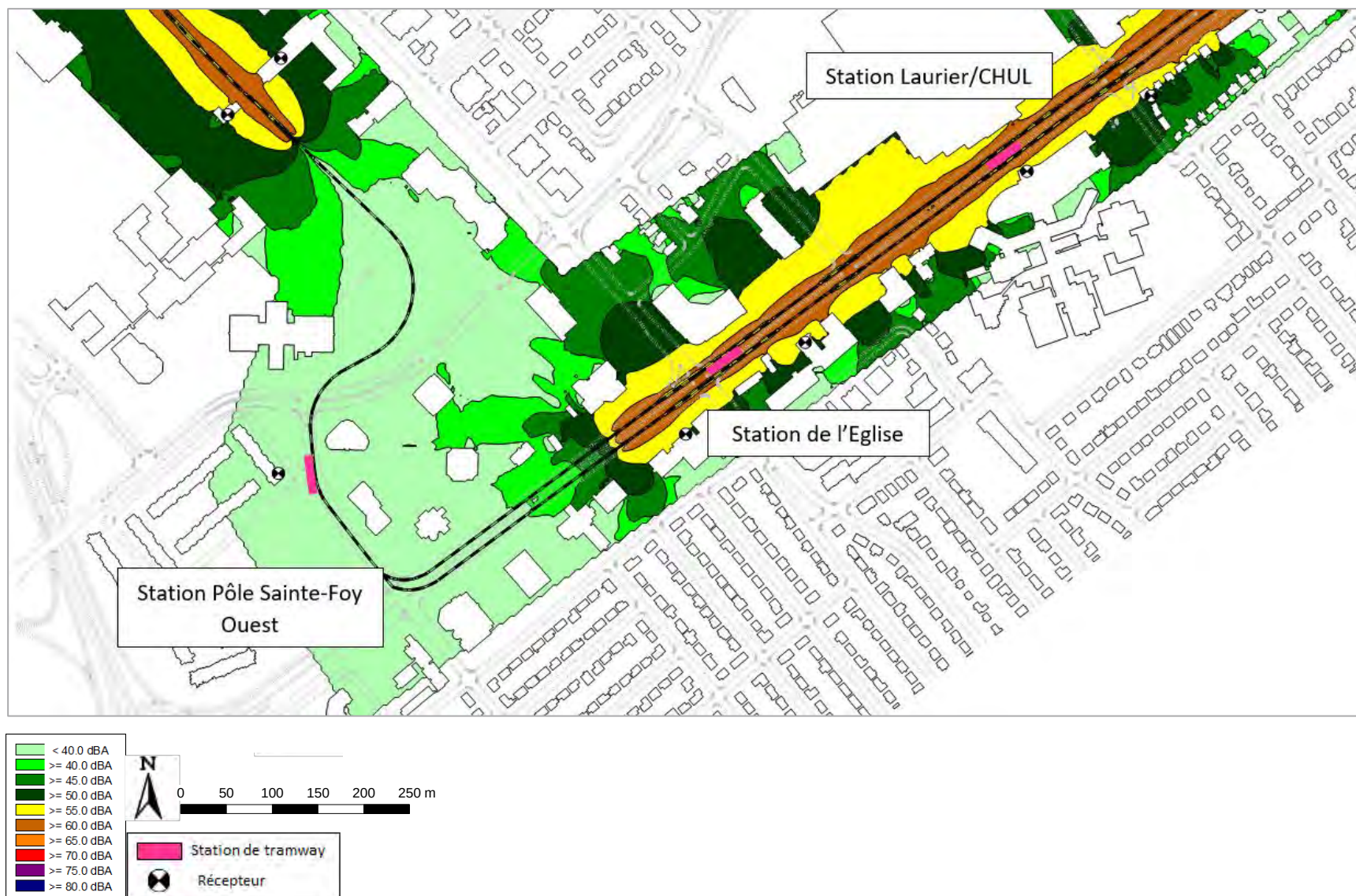
Figure 142 : Cartographie de bruit pour le tramway seul avec mesures de réduction – Secteur Sainte-Foy Ouest – Niveau de bruit L_p – Hauteur 4 m – Échelle 1/4000 e
