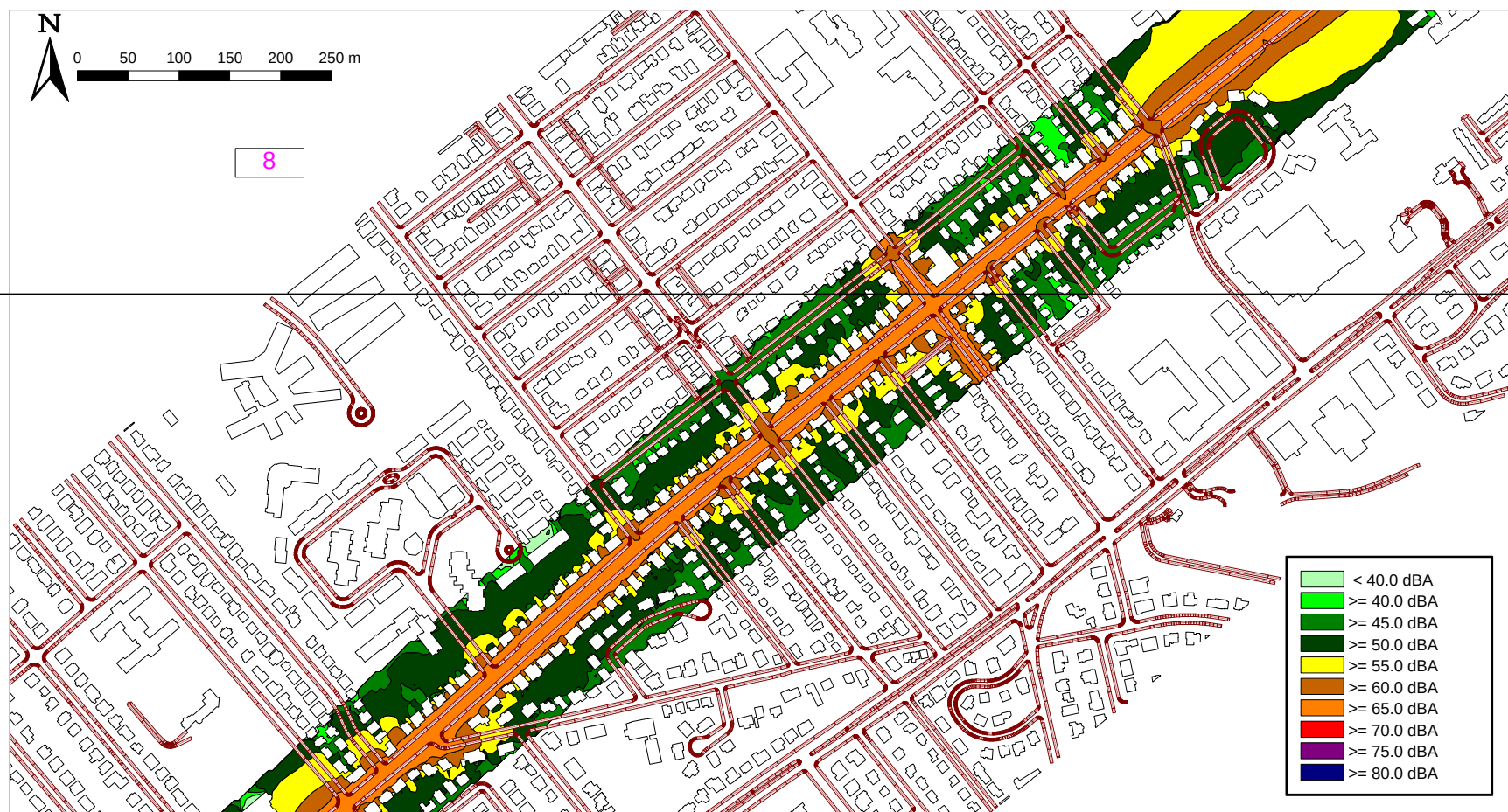
Figure 32 : Cartographie de bruit – Secteur Holland – Niveau de bruit L_p – Hauteur 4 m – Échelle 1/4000°
