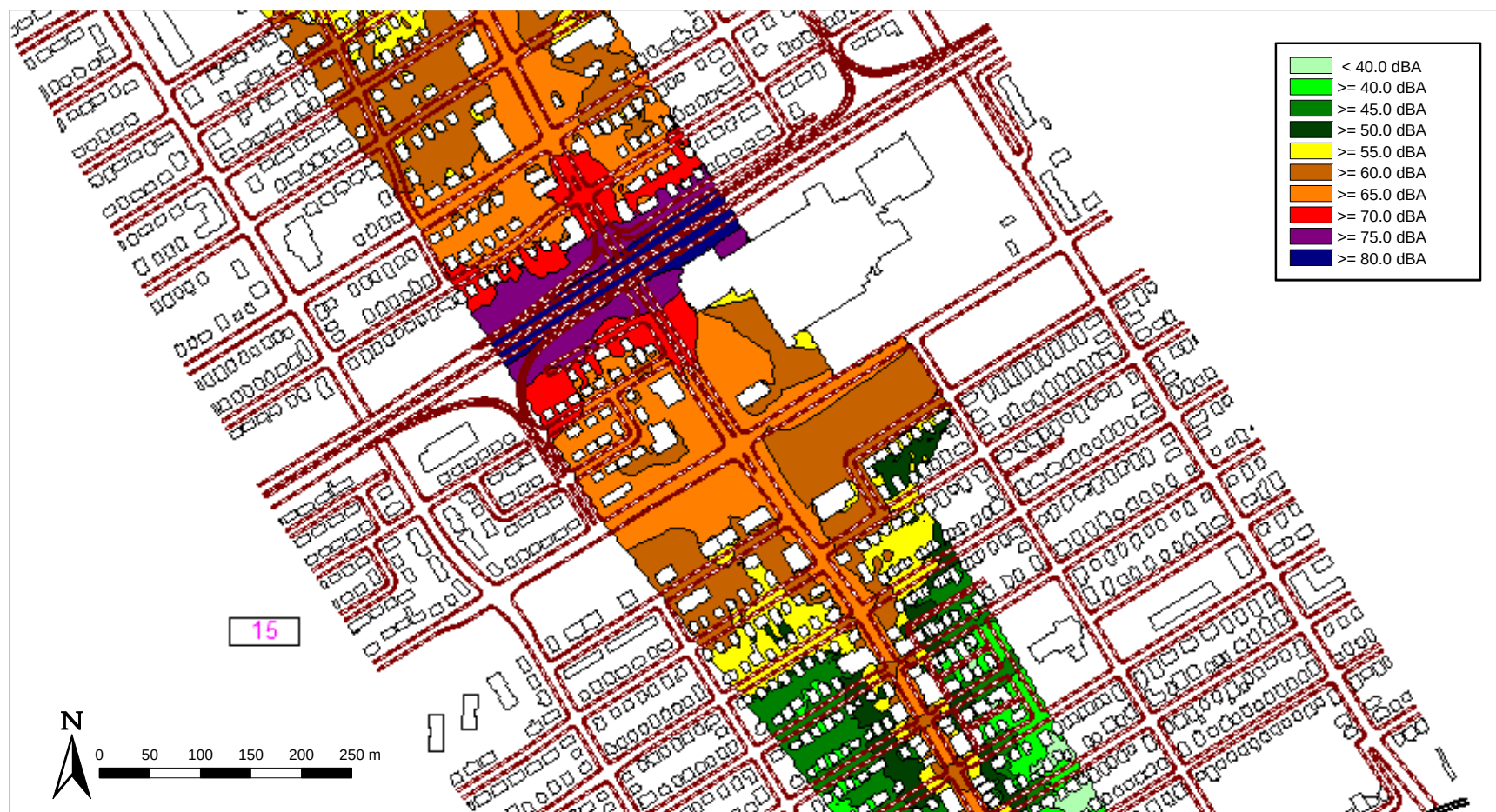
Figure 46 : Cartographie de bruit – Secteur 41 e Rue – Niveau de bruit L_D – Hauteur 4 m – Échelle 1/4000 e
