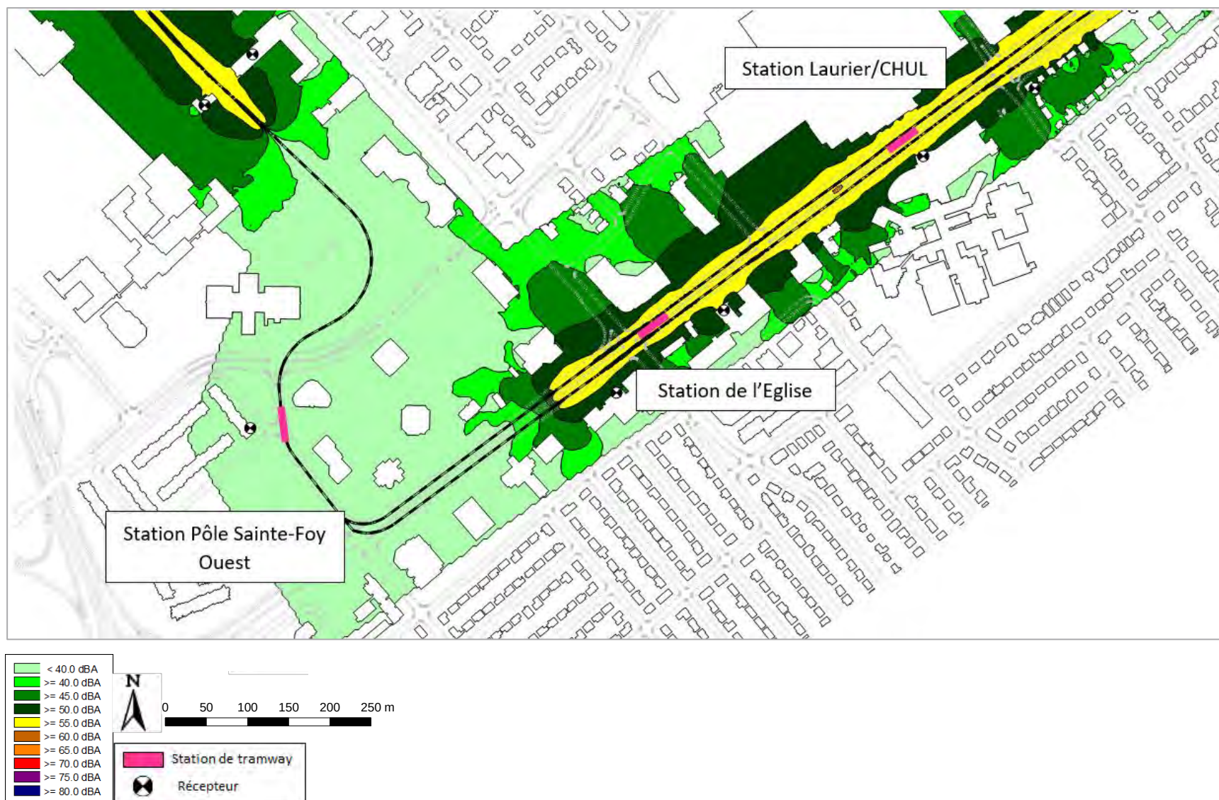
Figure 143 : Cartographie de bruit pour le tramway seul avec mesures de réduction – Secteur Sainte-Foy Ouest – Niveau de bruit L_n – Hauteur 4 m – Échelle 1/4000 e
