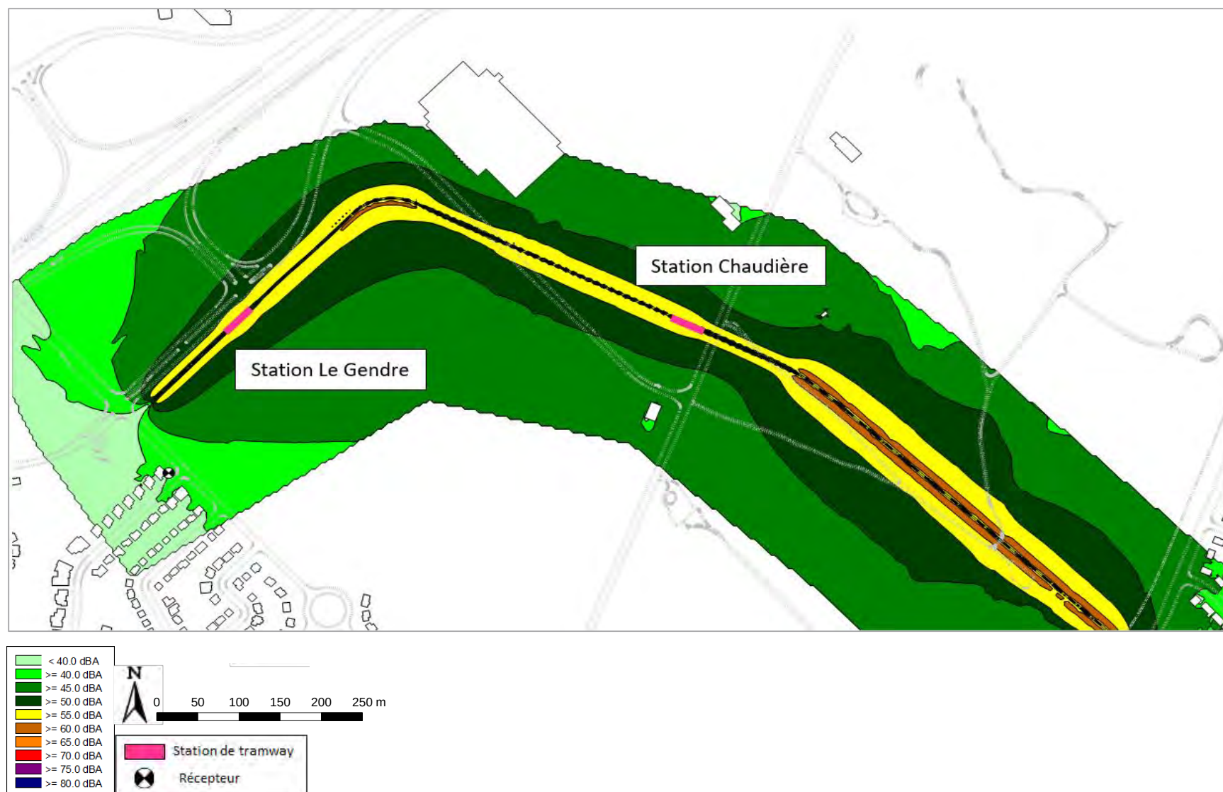
Figure 131 : Cartographie de bruit pour le tramway seul avec mesures de réduction – Secteur Le Gendre – Niveau de bruit L_N – Hauteur 4 m – Échelle 1/4000 e
