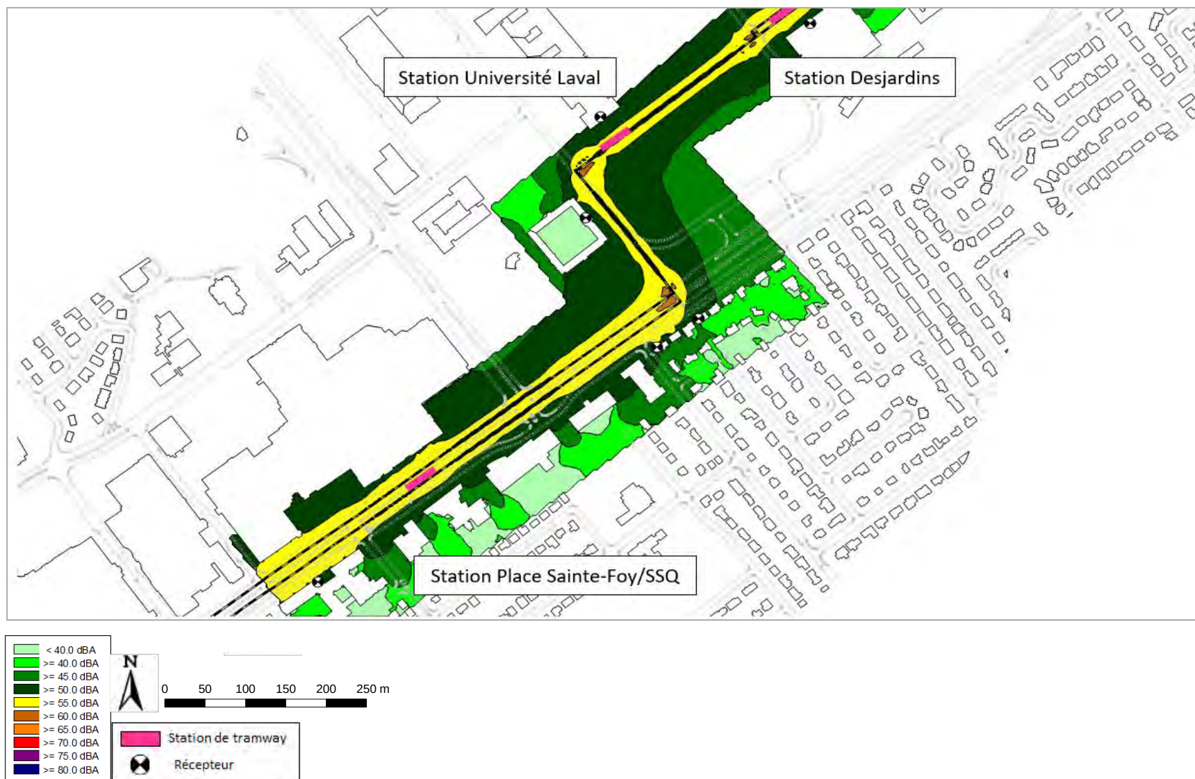
Figure 146 : Cartographie de bruit pour le tramway seul avec mesures de réduction – Secteur Université Laval – Niveau de bruit L_N – Hauteur 4 m – Échelle 1/4000 e
