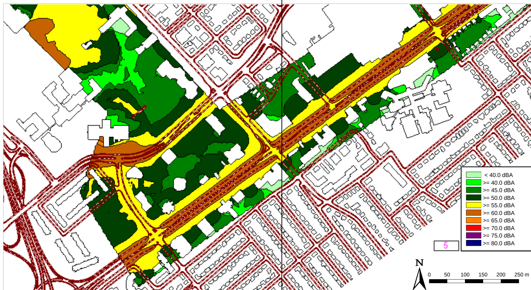
Figure 27 : Cartographie de bruit – Secteur Sainte-Foy– Niveau de bruit L_N – Hauteur 4 m – Échelle 1/4000 e
