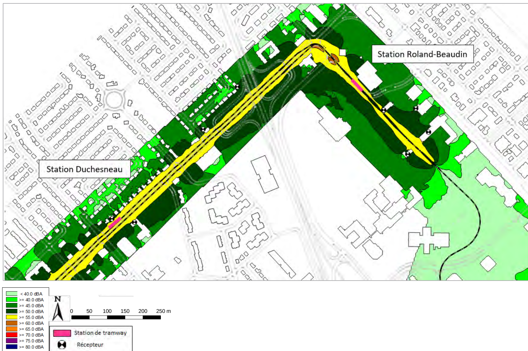
Figure 140 : Cartographie de bruit pour le tramway seul avec mesures de réduction – Secteur Roland-Beaudin – Niveau de bruit L_N – Hauteur 4 m – Échelle 1/4000 e
