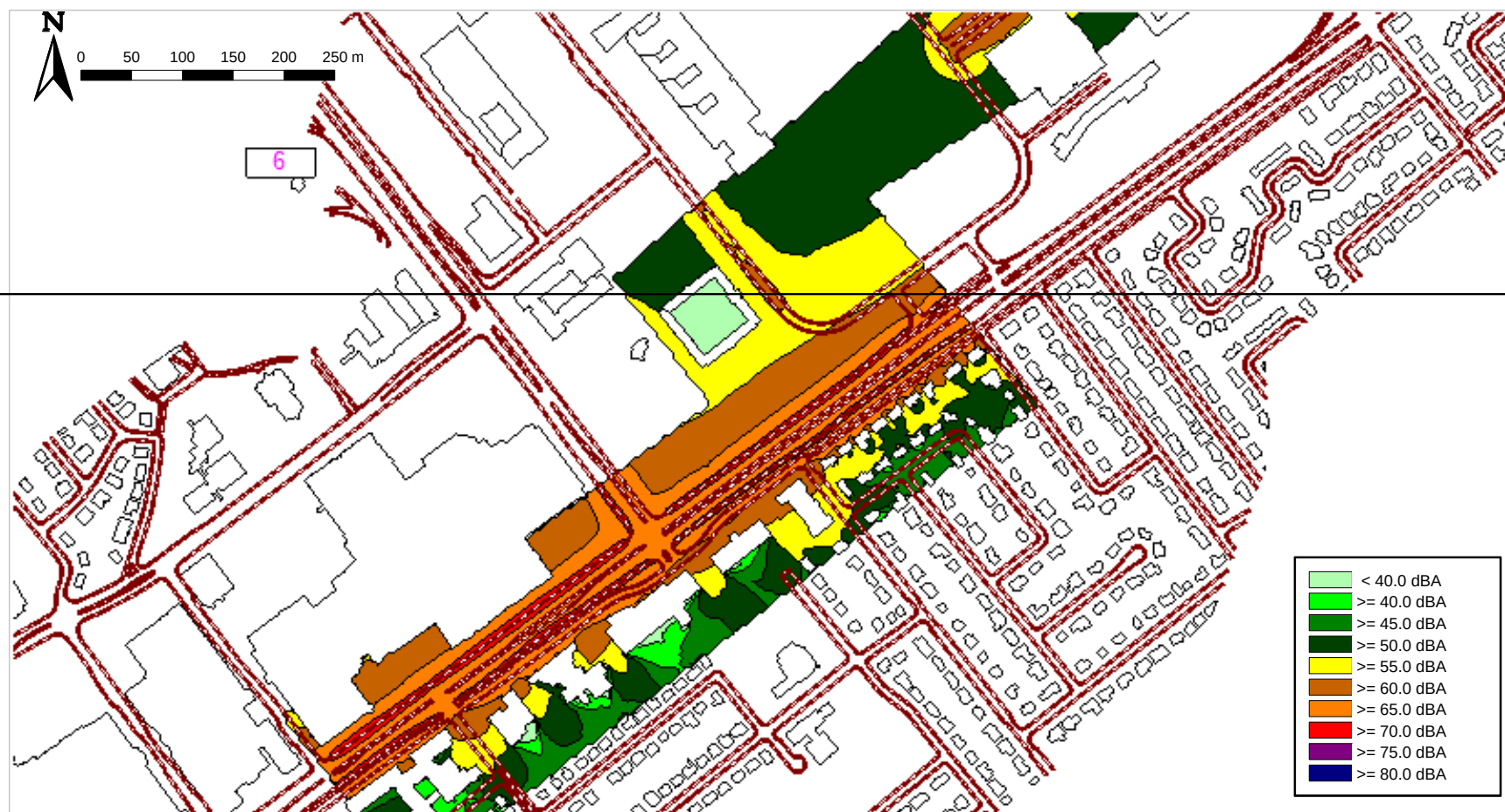
Figure 28 : Cartographie de bruit – Secteur Université Laval – Niveau de bruit L_p – Hauteur 4 m – Échelle 1/4000 e
