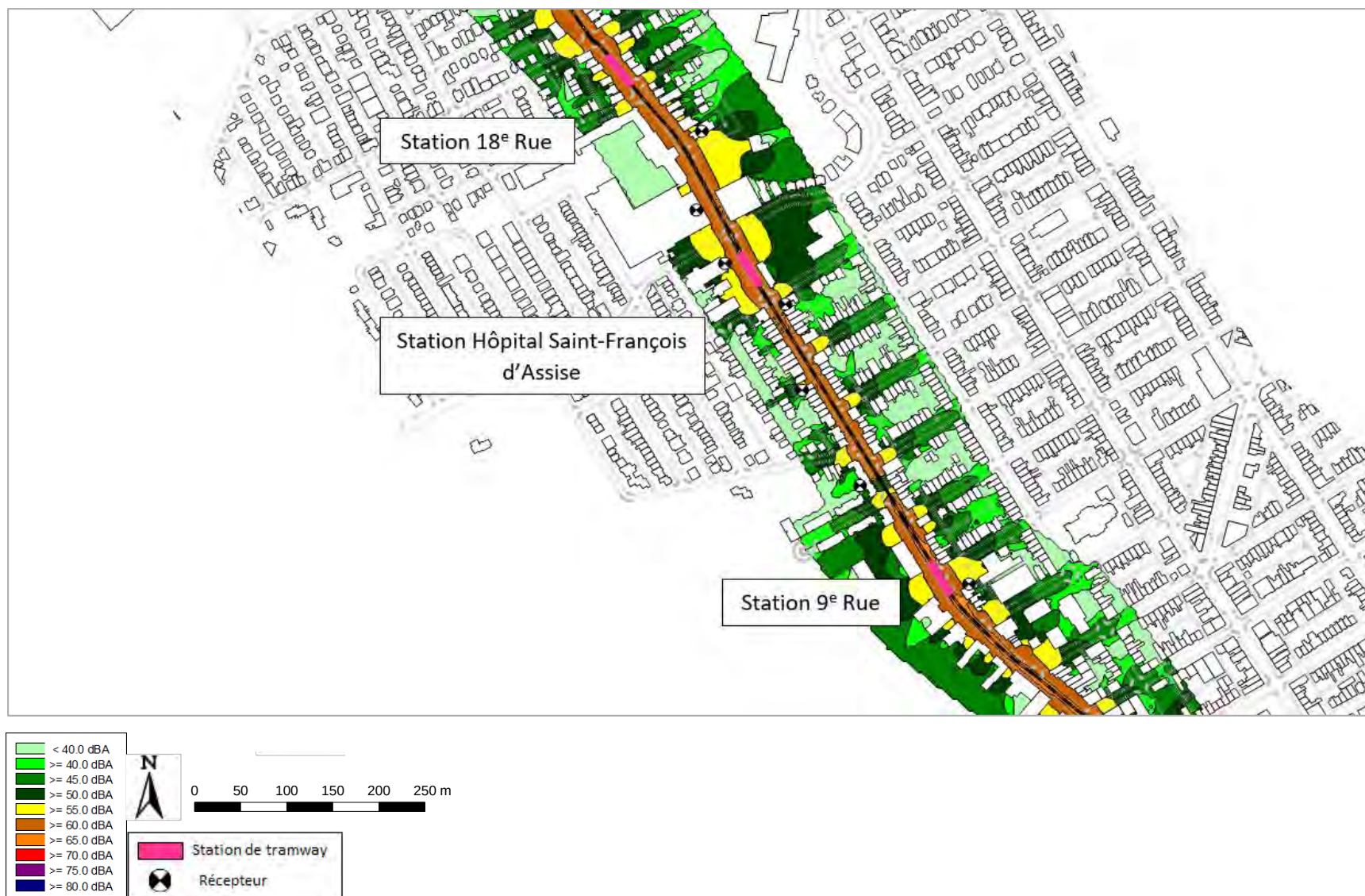
Figure 93 : Cartographie de bruit pour le tramway seul – Secteur Hôpital St-François d'Assise – Niveau de bruit LD – Hauteur 4 m – Échelle 1/4000 e
