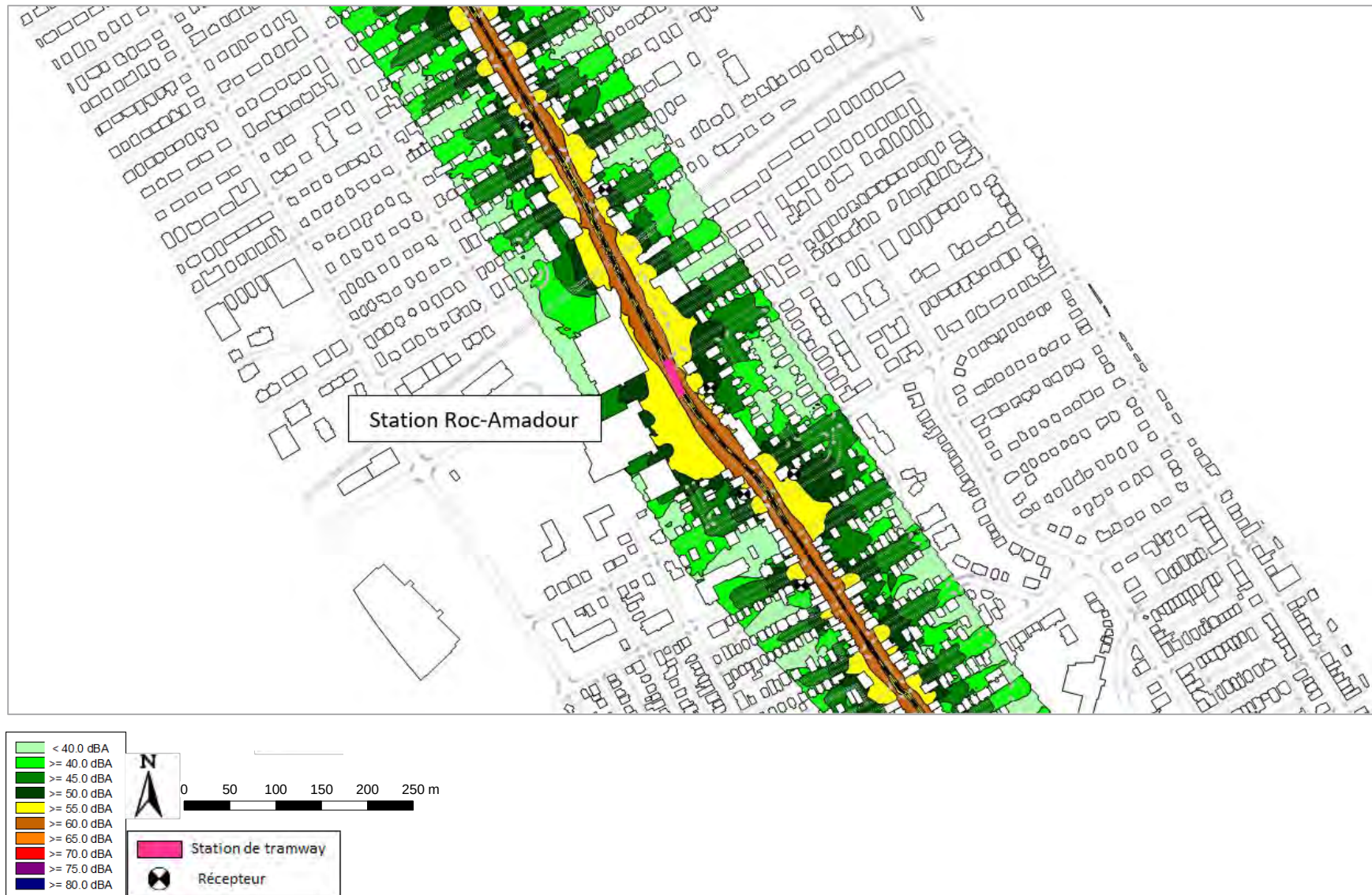
Figure 169 : Cartographie de bruit pour le tramway seul avec mesures de réduction – Secteur Patro Roc-Amadour – Niveau de bruit LD – Hauteur 4 m – Échelle 1/4000 e
