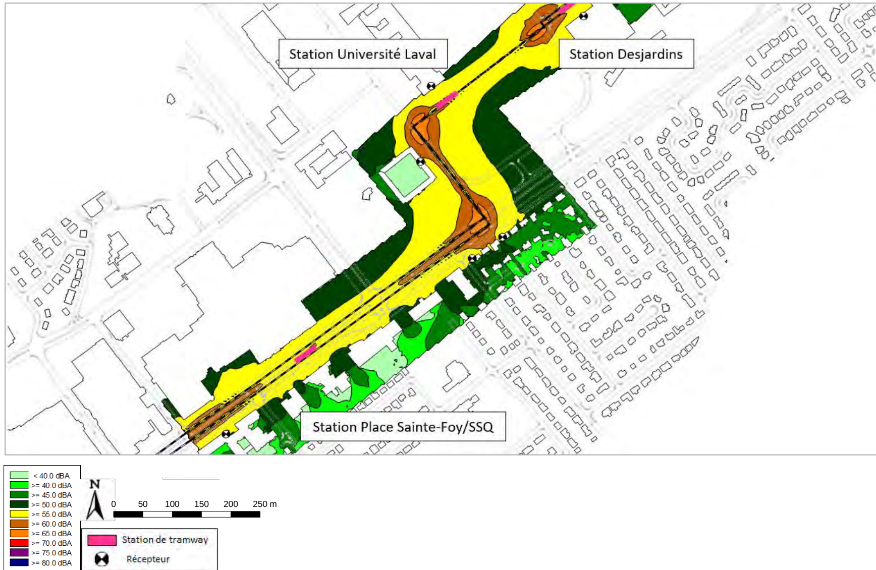
Figure 73 : Cartographie de bruit pour le tramway seul – Secteur Université Laval – Niveau de bruit LN – Hauteur 4 m – Échelle 1/4000 e
