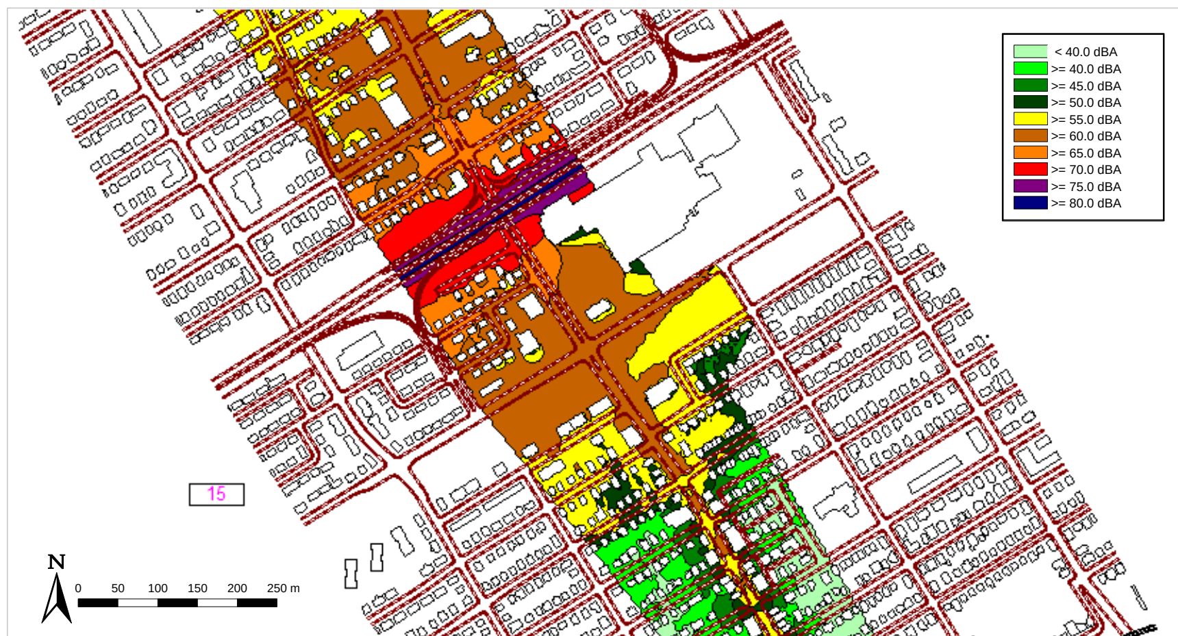
Figure 47 : Cartographie de bruit – Secteur 41 e Rue – Niveau de bruit L_N – Hauteur 4 m – Échelle 1/4000 e
