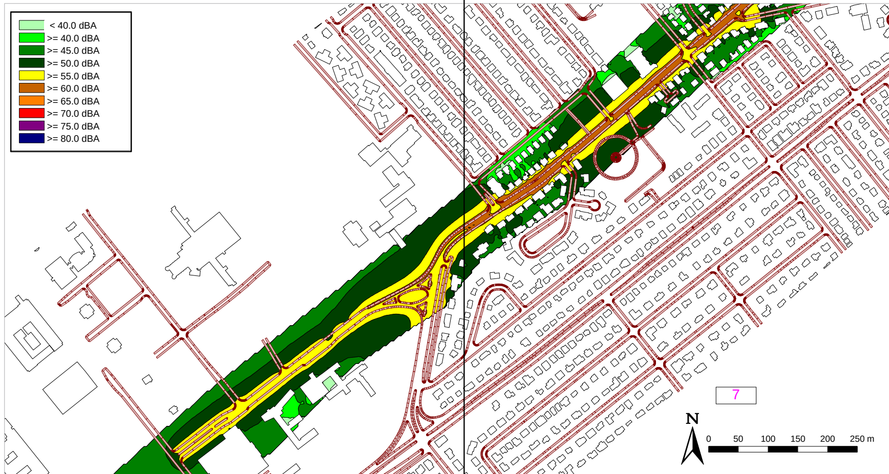
Figure 31 : Cartographie de bruit – Secteur Desjardins – Niveau de bruit L_N – Hauteur 4 m – Échelle 1/4000°
