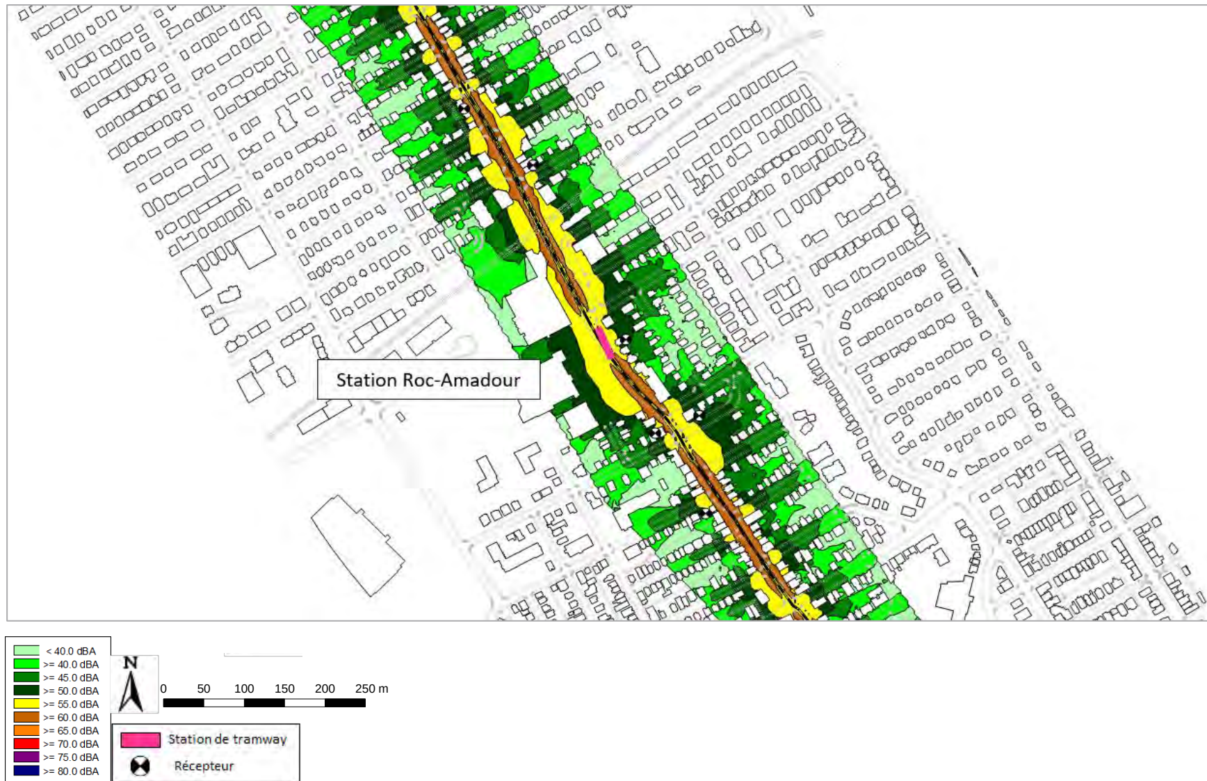
Figure 97 : Cartographie de bruit pour le tramway seul – Secteur Patro Roc Amadour – Niveau de bruit LN – Hauteur 4 m – Échelle 1/4000 e
