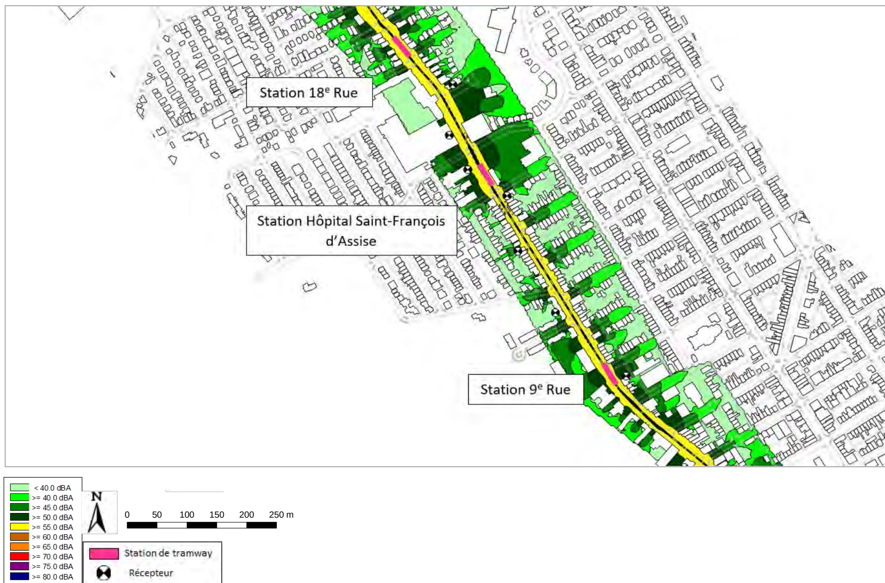
Figure 167 : Cartographie de bruit pour le tramway seul avec mesures de réduction – Secteur Hôpital St Fr. d'Assise – Niveau de bruit LN – Hauteur 4 m – Échelle 1/4000 e
