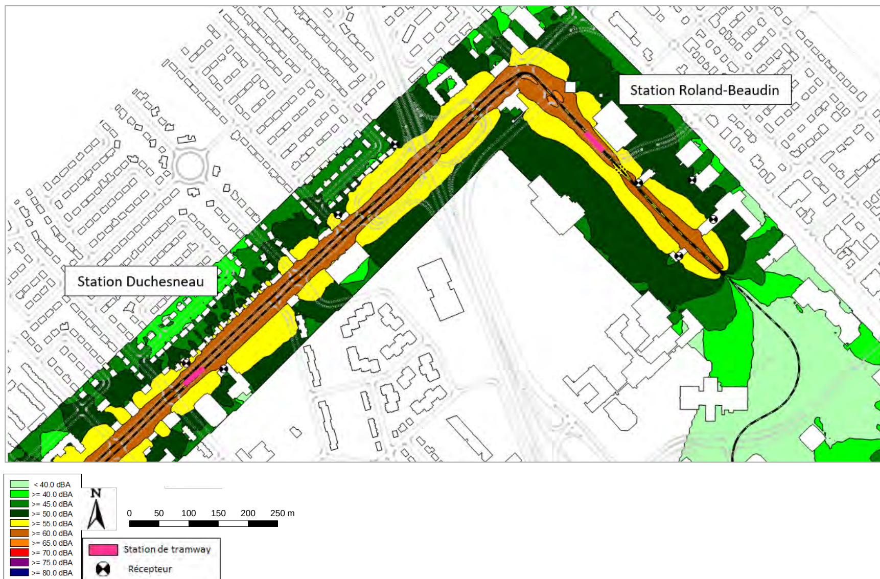
Figure 139 : Cartographie de bruit pour le tramway seul avec mesures de réduction – Secteur Roland-Beaudin – Niveau de bruit L_p – Hauteur 4 m – Échelle 1/4000 e
