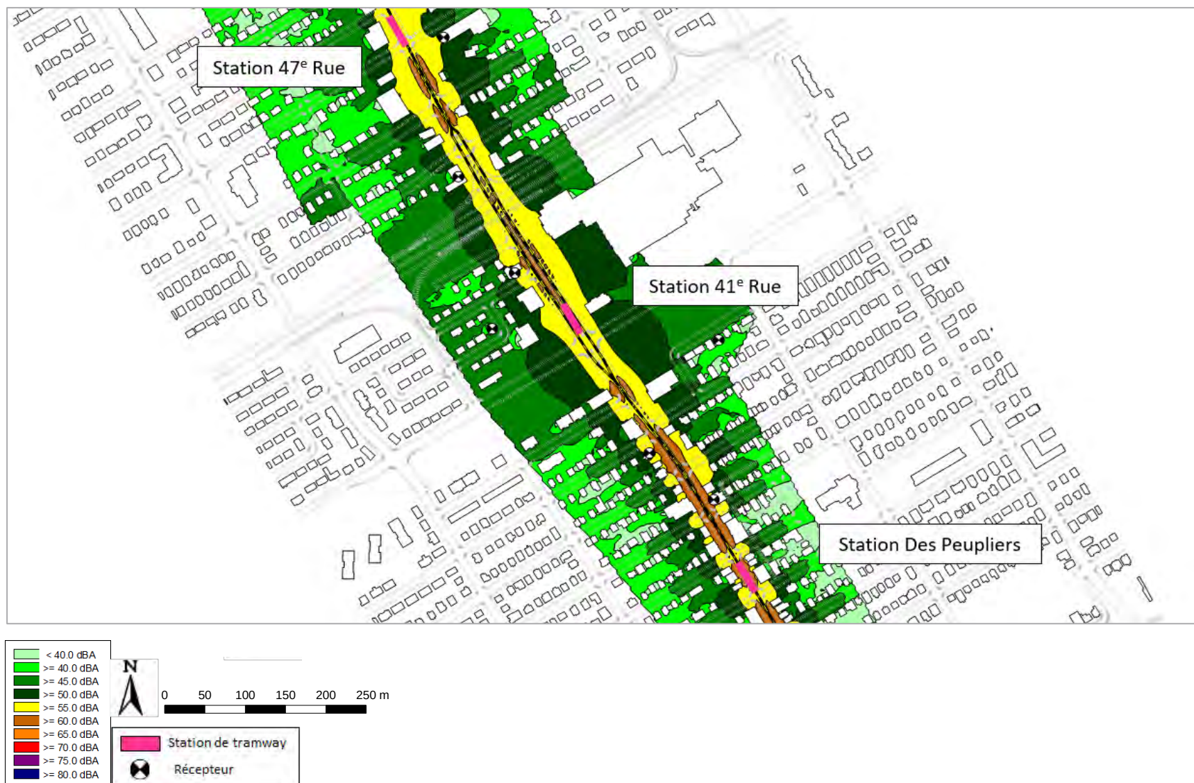
Figure 100 : Cartographie de bruit pour le tramway seul – Secteur 41 e Rue – Niveau de bruit LN – Hauteur 4 m – Échelle 1/4000 e
