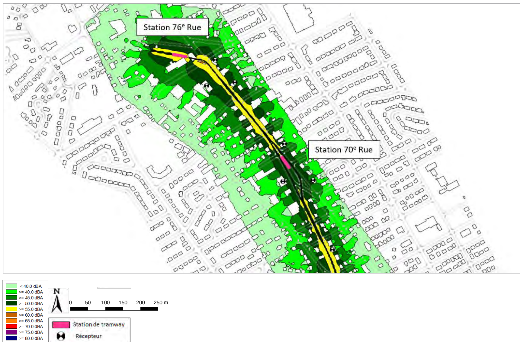
Figure 179 : Cartographie de bruit pour le tramway seul avec mesures de réduction – Secteur 76 e Rue – Niveau de bruit L_N – Hauteur 4 m – Échelle 1/4000 e
