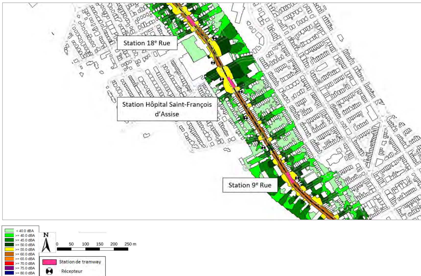
Figure 94 : Cartographie de bruit pour le tramway seul – Secteur Hôpital St-François d'Assise – Niveau de bruit LN – Hauteur 4 m – Échelle 1/4000 e
