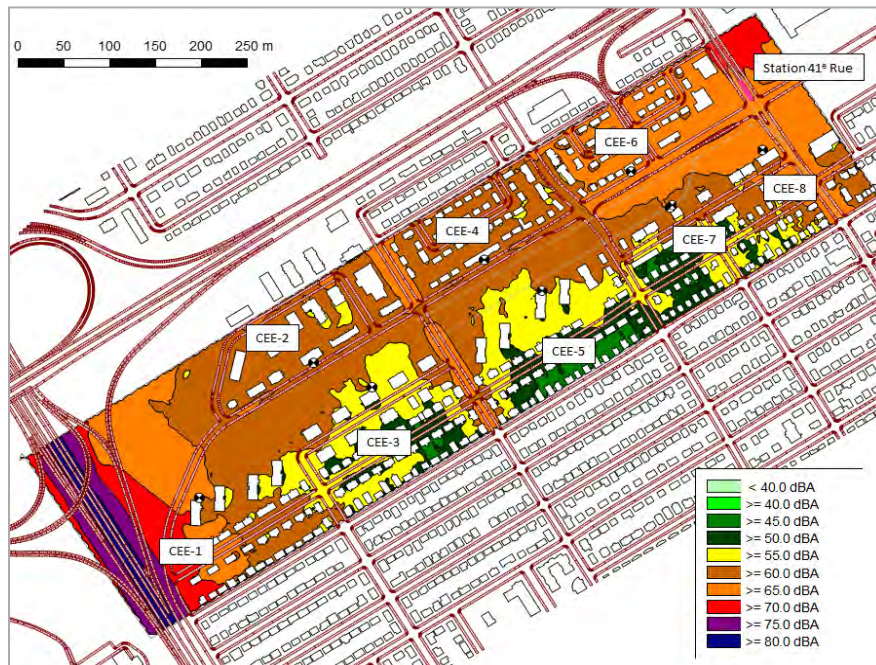
Figure 183 : Cartographie de l'ambiance sonore existante dans le secteur du second CEE – Niveau de bruit L_p – Hauteur 4 m – Échelle 1/4000 e
