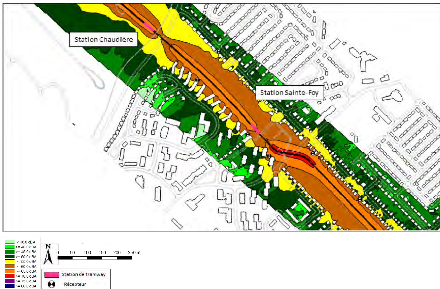
Figure 60 : Cartographie de bruit pour le tramway seul – Secteur Saint-Foy – Niveau de bruit LD – Hauteur 4 m – Échelle 1/4000 e
