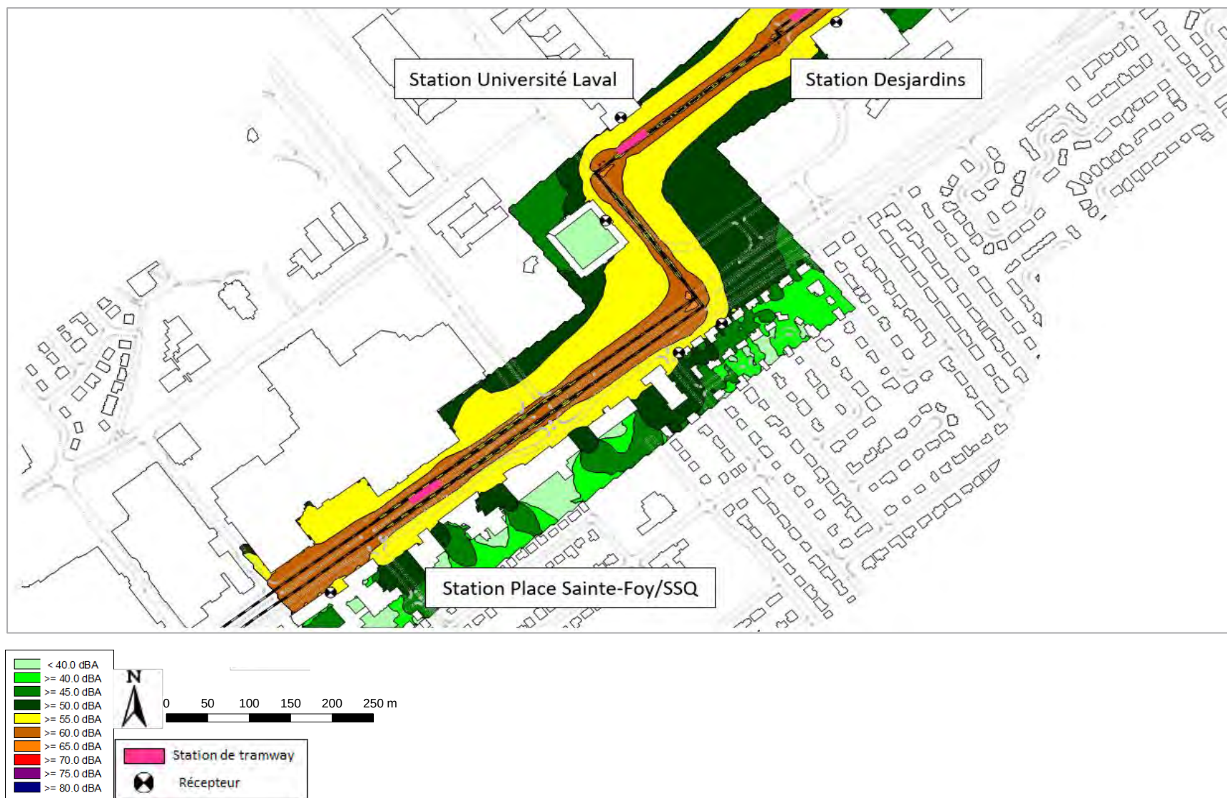
Figure 145 : Cartographie de bruit pour le tramway seul avec mesures de réduction – Secteur Université Laval – Niveau de bruit L_D – Hauteur 4 m – Échelle 1/4000 e
