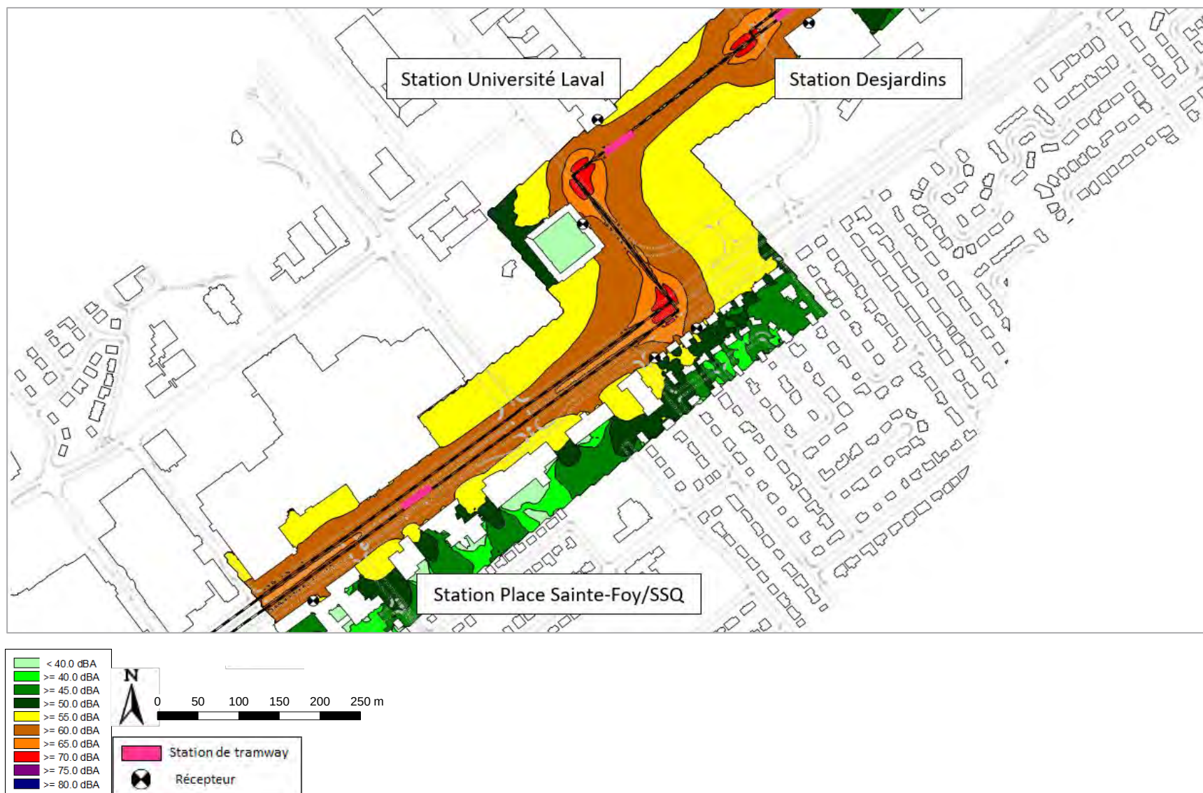
Figure 72 : Cartographie de bruit pour le tramway seul – Secteur Université Laval – Niveau de bruit LD – Hauteur 4 m – Échelle 1/4000 e
