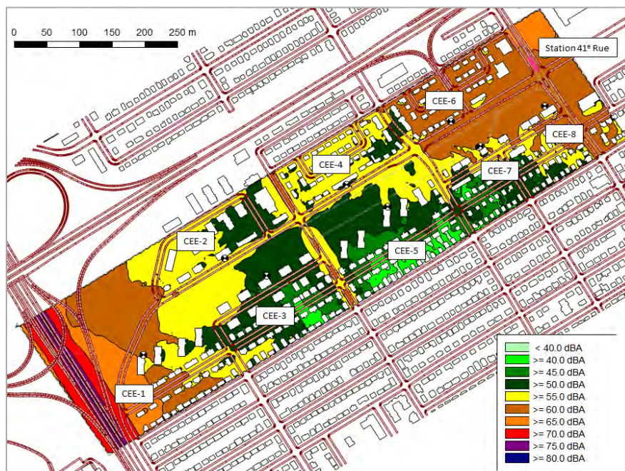
Figure 184 : Cartographie de l'ambiance sonore existante dans le secteur du second CEE – Niveau de bruit L_n – Hauteur 4 m – Échelle 1/4000 e
