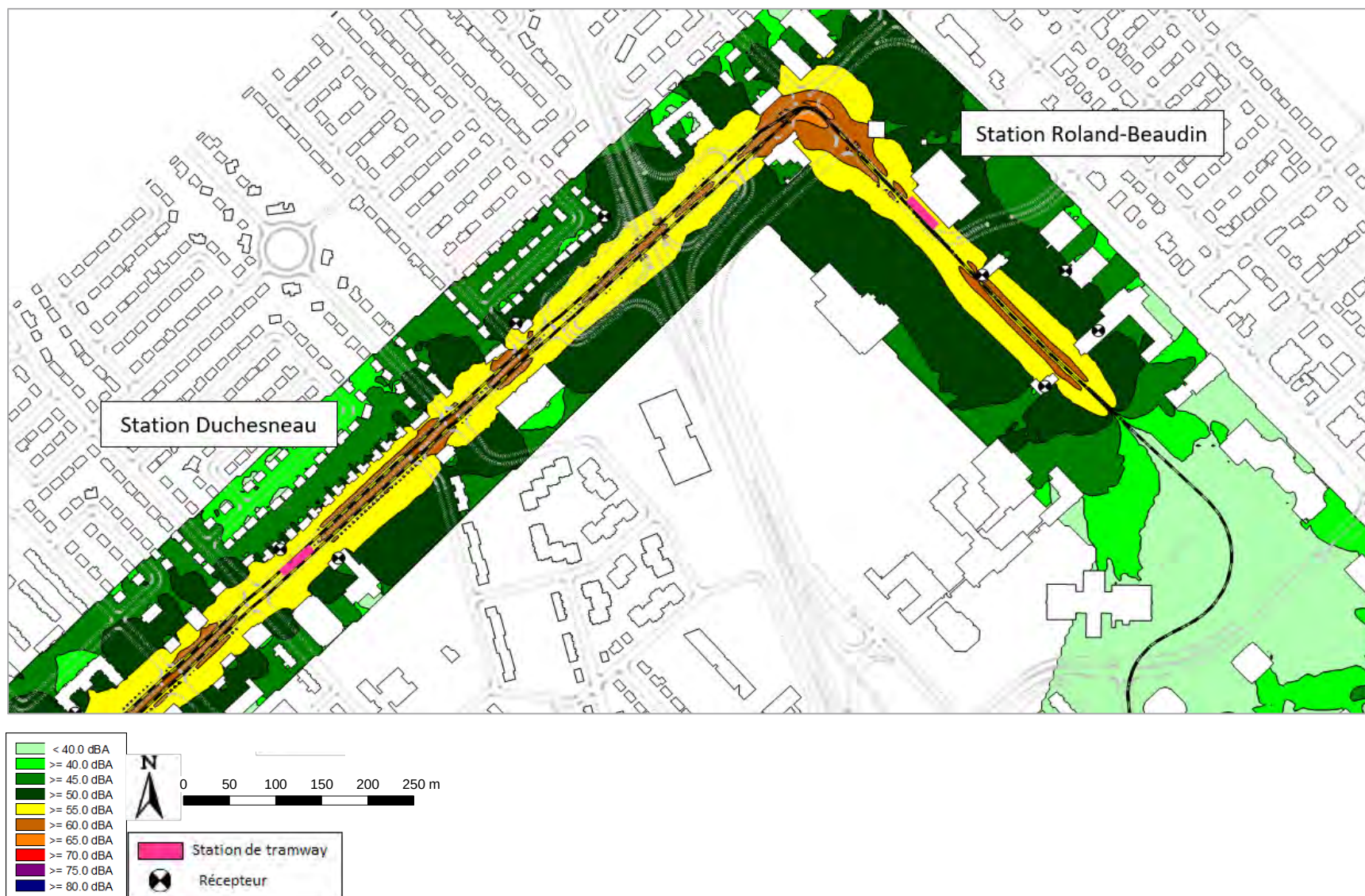
Figure 67 : Cartographie de bruit pour le tramway seul – Secteur Roland-Beaudin – Niveau de bruit LN – Hauteur 4 m – Échelle 1/4000°
