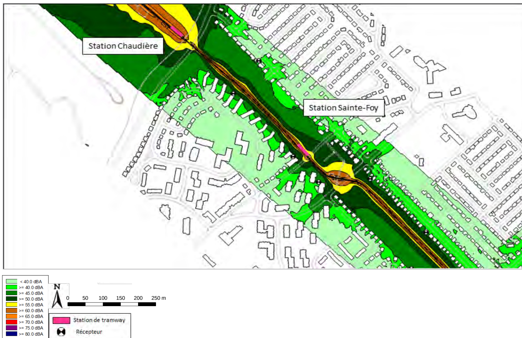
Figure 133 : Cartographie de bruit pour le tramway seul avec mesures de réduction – Secteur Sainte-Foy – Niveau de bruit L_p – Hauteur 4 m – Échelle 1/4000°
