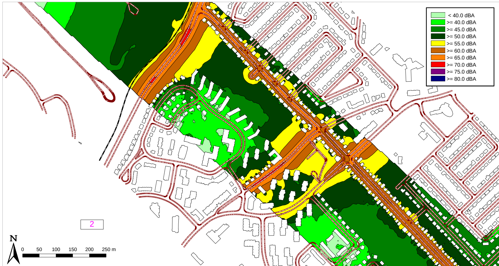
Figure 20 : Cartographie de bruit – Secteur Sainte-Foy – Niveau de bruit L_p – Hauteur 4 m – Échelle 1/4000 e
