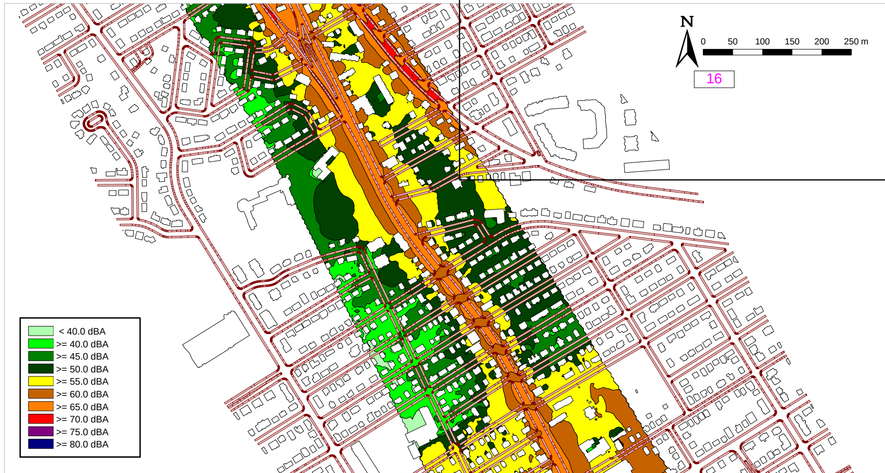
Figure 48 : Cartographie de bruit – Secteur 55 e Rue – Niveau de bruit L_p – Hauteur 4 m – Échelle 1/4000 e
