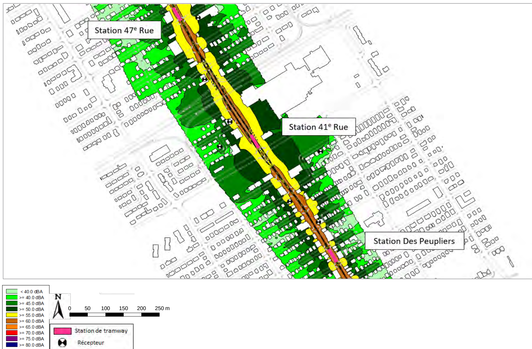
Figure 172 : Cartographie de bruit pour le tramway seul avec mesures de réduction – Secteur 41 e Rue – Niveau de bruit LD – Hauteur 4 m – Échelle 1/4000 e
