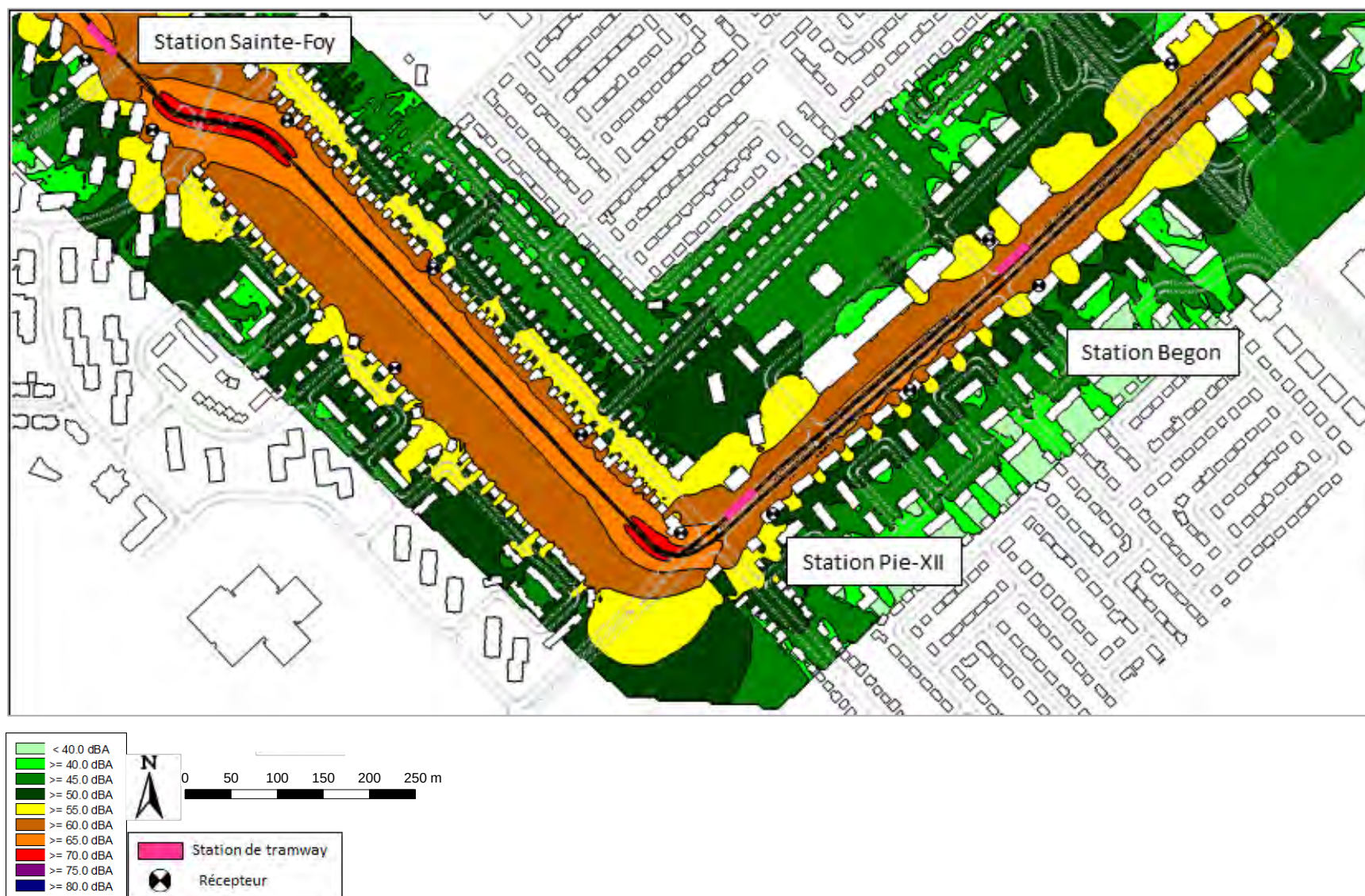
Figure 63 : Cartographie de bruit pour le tramway seul – Secteur Pie-XII – Niveau de bruit LD – Hauteur 4 m – Échelle 1/4000 e
